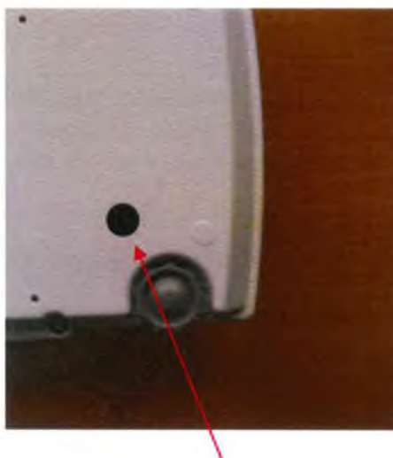
Рисунок 2 – Схема пломбировки весов
