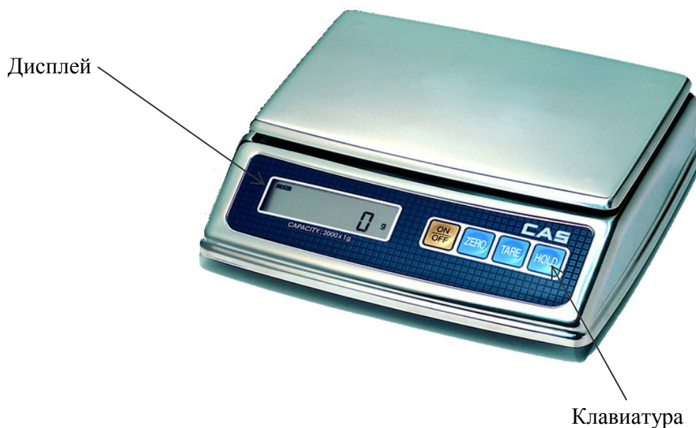
Рисунок 4.1 – Общий вид весов, основные элементы
