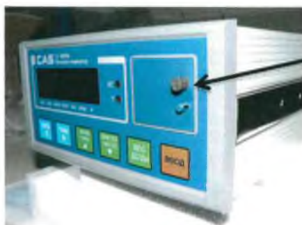
Рисунок 4 - Схема пломбировки блока управления
